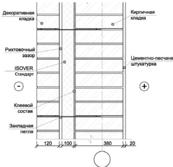
Требуемое сопротивление теплопередаче определяется по методике СП 50.13330.2012 «Тепловая защита зданий».
